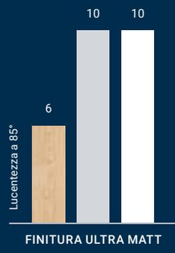
Riflettanza a un angolo di incidenza di 85° (in conformità alla norma ISO 2813).
