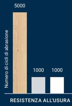
Grado di resistenza all'usura (in conformità alla norma EN ISO 16094).
