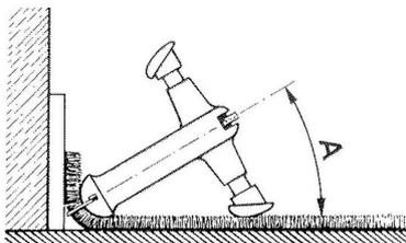
Brevettata. Utensile ideale per una rifilatura perfetta, rapida e senza segni di tutti i tipi di rivestimenti da pavimento. Due regolazioni per adattare il taglio al tipo di rivestimento:
