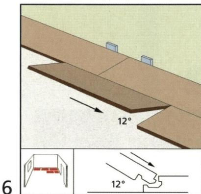
**(6)** Inserire una doga intera prima sul lato lungo mantenendo una inclinazione di 12° e poi abbassarla.
