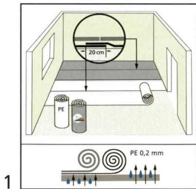
**(1)** Stendere sul pavimento esistente o massetto il materassino scelto con barriera a vapore in aderenza al sottofondo. Sormontare per circa 20 cm le varie parti tagliate dal rotolo del materassino per garantire che l'umidità non risalga. **NOTA BENE:** alcuni materassini hanno predisposto la cimosa per il sormonto.
