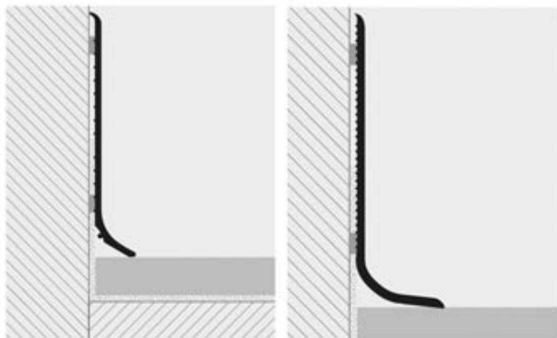
**1:** Scegliere il Battiscopa di altezza desiderata 60 / 120mm specificando il colore. **2:** Posare il profilo facendo attenzione di calcolare la larghezza dei raccordi interni/esterni (solo per la versione H: 60 mm). **3:** La posa deve essere effettuata usando il silicone acrilico a fissaggio rapido, matice o bostik, adatto per incollare PVC flessibile con malta, intonaco, pareti attrezzate ecc., oppure fissare con viti/chiodi.
